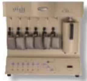
آماده ساز نمونه به صورت طلایی – استاندارد برای آنالایزر جذب فیزیکی می باشد که توسط کامپیوتر به منظور کنترل تمام مناطق گرمایشی توسط رمپ ویژه گرمایشی و دفعات آن ها محافظت می شود. بخش های سرد ساخته شده، حذف کارآمد را در پیل سوختی و سیستم خلاء را ایجاد می کند. نسخه توربو پمپ برای انفجار سریع با خلاء سریع در دسترس است.
