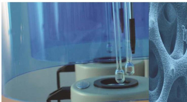
اندازه گیری سطح ویژه BET و تخلخل سنج مدل Auto sorb محصول شرکت Quantachrome از برترین محصولات اندازه گیری سطح ویژه BET ، تخلخل سنج ، اندازه گیری جذب شیمیایی و جذب فیزیکی و اندازه گیری جذب سطحی می باشد.
