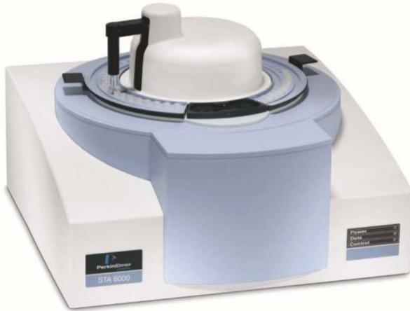
شبیه ساز آنالیز حرارتی STA-8000 مدل STA می باشد که تلفیقی از گرماسنچ روشی افتراقی DSC و نیز آنالیز توزین حرارتی TGA است . شبیه ساز آنالیز حرارتی STA مدل STA-6000 قادر به تولید نتایج دقیق و قابل اعتماد در عین حال تفسیر ساده از آنالیز حرارتی نمونه ها را فراهم می آورد .
