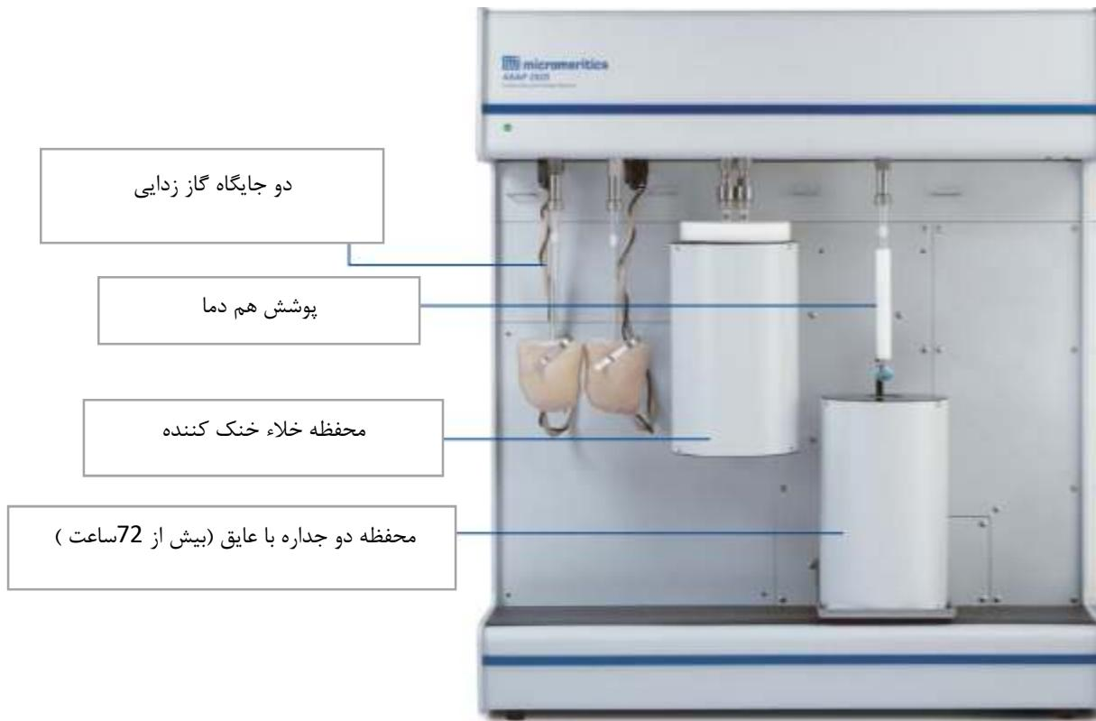
اندازه گیری مساحت سطح و تخلخل سنج مدل ASAP 2020 مجهز به شش ورودی گاز تجزیه کننده برای آزمایش های جذب سطحی فیزیکی است. ورودی بخار و ورودی هلیوم برای فضای آزاد نیز گنجانده شده است. شش ورودی اضافی با جذب سطحی شیمیایی در دسترس هستند. که انعطاف پذیری بیشتری را فراهم می کند و انتخاب خودکار پیش پردازش، و تجزیه و تحلیل گازها را اجازه می دهد.
