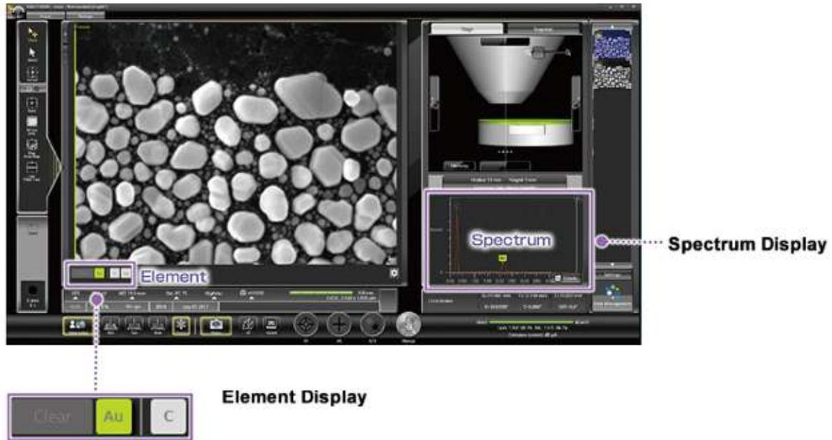
از جمله ویژگی های آنالیز لحظه ای با مدل های تحلیلی ، یک طیف EDS زمان واقعی را در هنگام مشاهده تصویر فراهم می کند. عناصر اصلی به طور خودکار در میکروسکوپ الکترونی روبشی SEM مدل JSM-IT500HR شناسایی می شوند و روی صفحه نمایش داده می شوند. پیدا کردن مواد خارجی یا تایید ترکیبات توسط میکروسکوپ الکترونی روبشی SEM مدل JSM-IT500HR انجام می شود .
