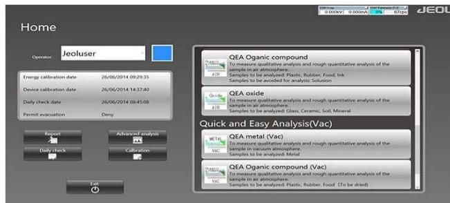
روش جدید هوشمند FP امکان به دست آوردن نتایج بسیار دقیق کمی را بدون نیاز به تهیه نمونه استاندارد در طیف سنجی فلورسانس اشعه ایکس JSX-1000S مدل JSX-1000S فراهم می کند و شامل اصلاح خودکار ضخامت و تعادل موجودی عنصر می باشد.
