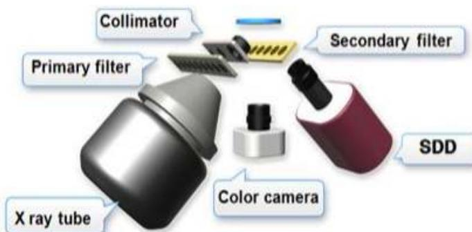
تجزیه و تحلیل حساسیت در کل محدوده انرژی، تجزیه و تحلیل حساسیت بالا را می‌توان در کل محدوده انرژی با استفاده از حداقل ۹ نوع فیلتر و واحد خلاء محفظه نمونه انجام داد. \* Cl, Cu, Mo, Sb آپشن ها هستند.
