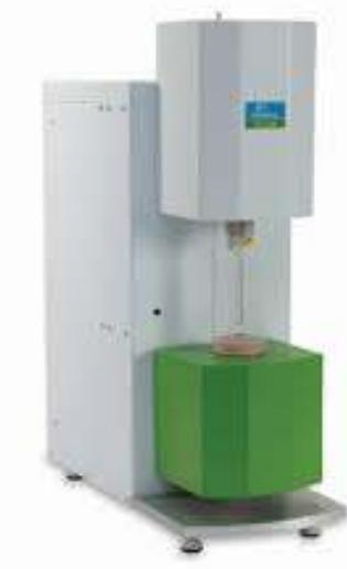
آنالیز گرما مکانیکی یا آنالیز ترمومکانیکی Thermomechanical Analyzer TMA-4000 مدل ساخت شرکت PerkinElmer کشور امریکا می باشد که قادر به اندازه گیری ویسکوالاستیسیته ( viscoelasticity ) مواد در محیط های مختلف است. آنالیز گرما مکانیکی TMA مدل TMA-9200 انبساط و انقباض گرمایی و stress relaxation نمونه های جامد را اندازه گیری می کند.
