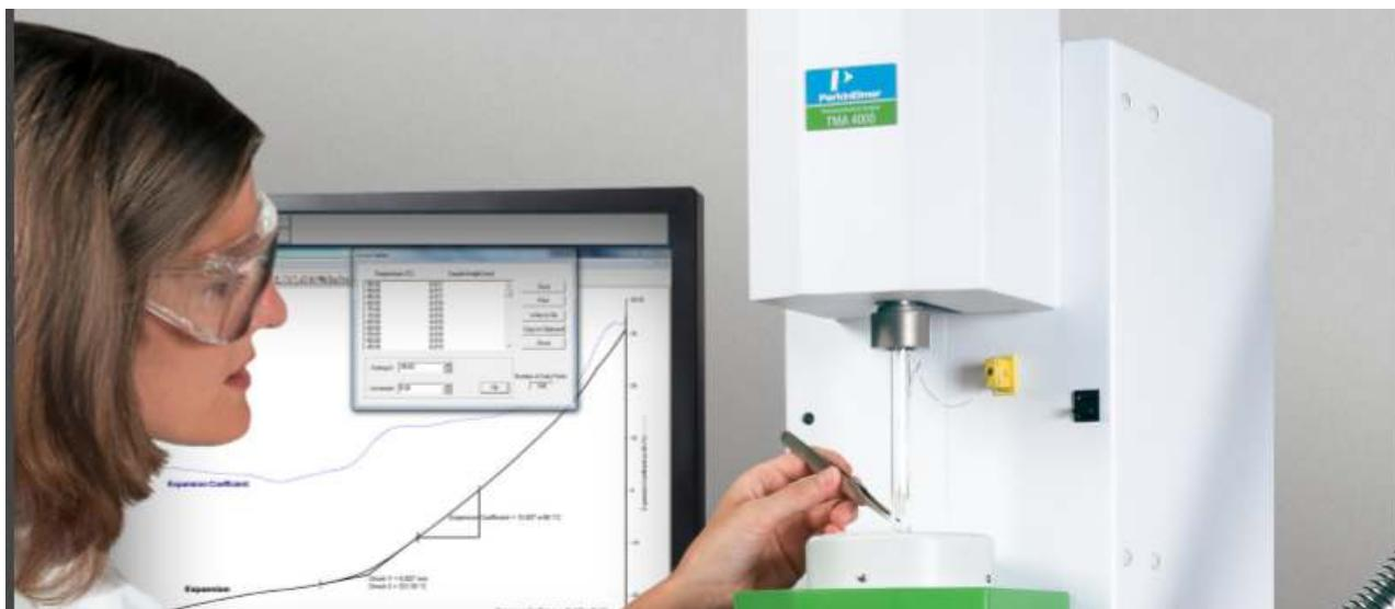
منبع اصلی تنش مکانیکی و شکست در اجزای الکترونیکی و همچنین دیگر محصولات در آنالیز ترمومکانیکی TMA-4000 انبساط حرارتی است. تعیین دقیق دمای انتقال شیشه‌ای که در آن مواد شروع به نرم شدن می‌کنند و موجب کاهش تنش می‌شود توسط آنالیز حرارتی مکانیکی TMA-4000 صورت می‌گیرد.
