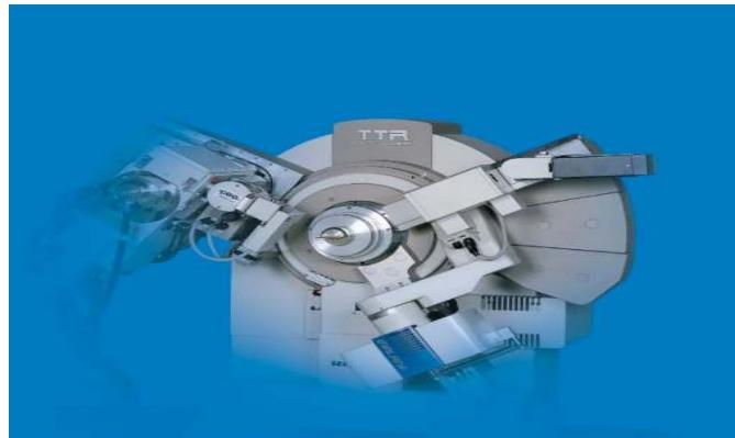
آنالیز پراش پرتو ایکس TTRAX III مدل XRD نشان دهنده وضعیت پیشرفته در سیستم های پراش اشعه ایکس XRD به صورت چند منظوره است. آنالیز پراش پرتو ایکس XRD می تواند بسیاری از اندازه گیری های مختلف را سریعاً انجام دهد. با استفاده از تکنولوژی پرتوهای متقطع (CBO) که برای همیشه قابل تنظیم، موازی و متمرکز به طور دائمی و برای کاربر انتخاب شده است آنالیز پراش پرتو ایکس TTRAX III مدل XRD یکی از بهترین محصولات آنالیز پراش اشعه ایکس XRD شرکت Rigaku کشور ژاپن می باشد.
