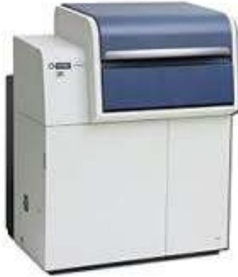
اسپکترومتر UV-Vis مدل UH4150 دارای سیستم اپتیکی پیشرفته ای است که حاوی منوکروماتور دوتایی و منشور در سیستم اپتیکی خود می باشد. اسپکتروسکوپی UV-Vis برای نمونه های جامد بسیار مناسب است. اسپکتروفوتومتر UV-Vis مدل UH4150 کمترین اثر پلاریزاسیون و کمترین میزان نویز را ارائه می دهد. این سیستم مجهز به دو کروماتور به همراه منشور است. تغییرات بزرگی در شدت نور پلاریزاسیون S و P برای سیستم منشور- گریت (P-G) کمتر از سیستم گریت - گریت (G-G) می باشد.
