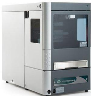
دستگاه اتوماتیک آنالیز اندازه ذرات Zetasizer Nano Sampler، نوعی سیستم دریافت کننده‌ی نمونه است که اجازه‌ی دریافت خودکار انواع نمونه‌های خیلی رقیق و یا خیلی غلیظ را به سیستم Zetasizer Nano می‌دهد.
